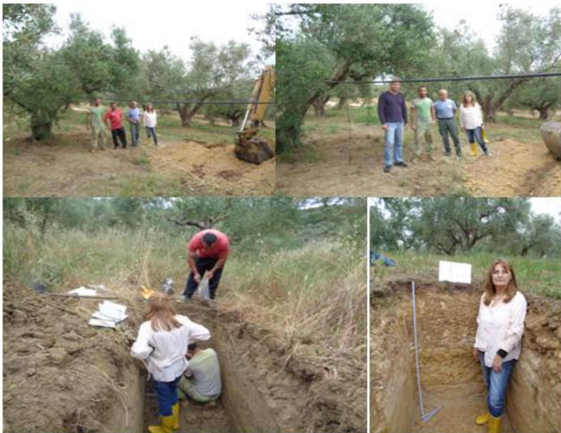
Εικόνα 2. Εκσκαφή εδαφοτομών και δειγματοληψίες εδαφικών προφίλ στη Χώρα Μεσσηνίας για τη ραδιοχρονολόγηση του C στο έδαφος (Μάιος 2017)
