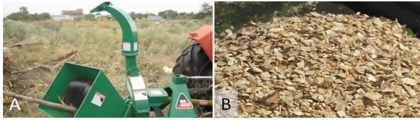
Εικόνα 2. Θρυμματισμός κλαδιών (Α) και τελικό προϊόν (Β).
